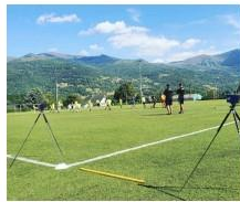
CELLULES PHOTOÉLECTRIQUES pour mesurer précisément la vitesse de déplacement
